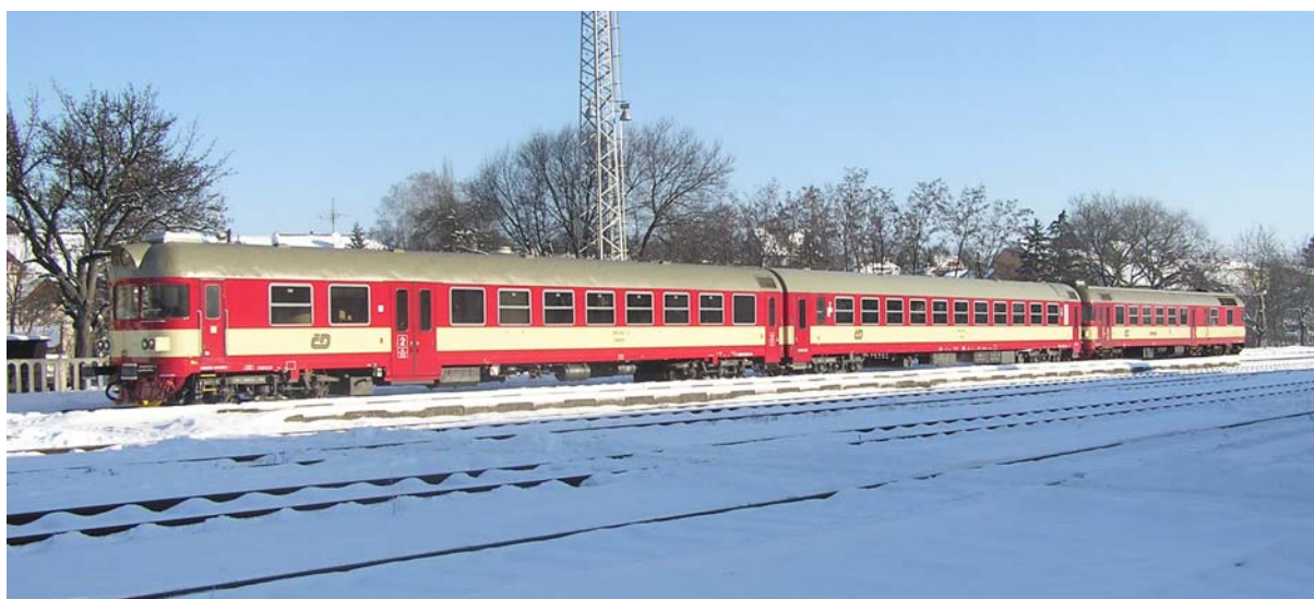
Řídicí vůz řady 954 v soupravě s motorovým vozem 854 a přípojným vozem 054, Foto. archiv Pars nova
