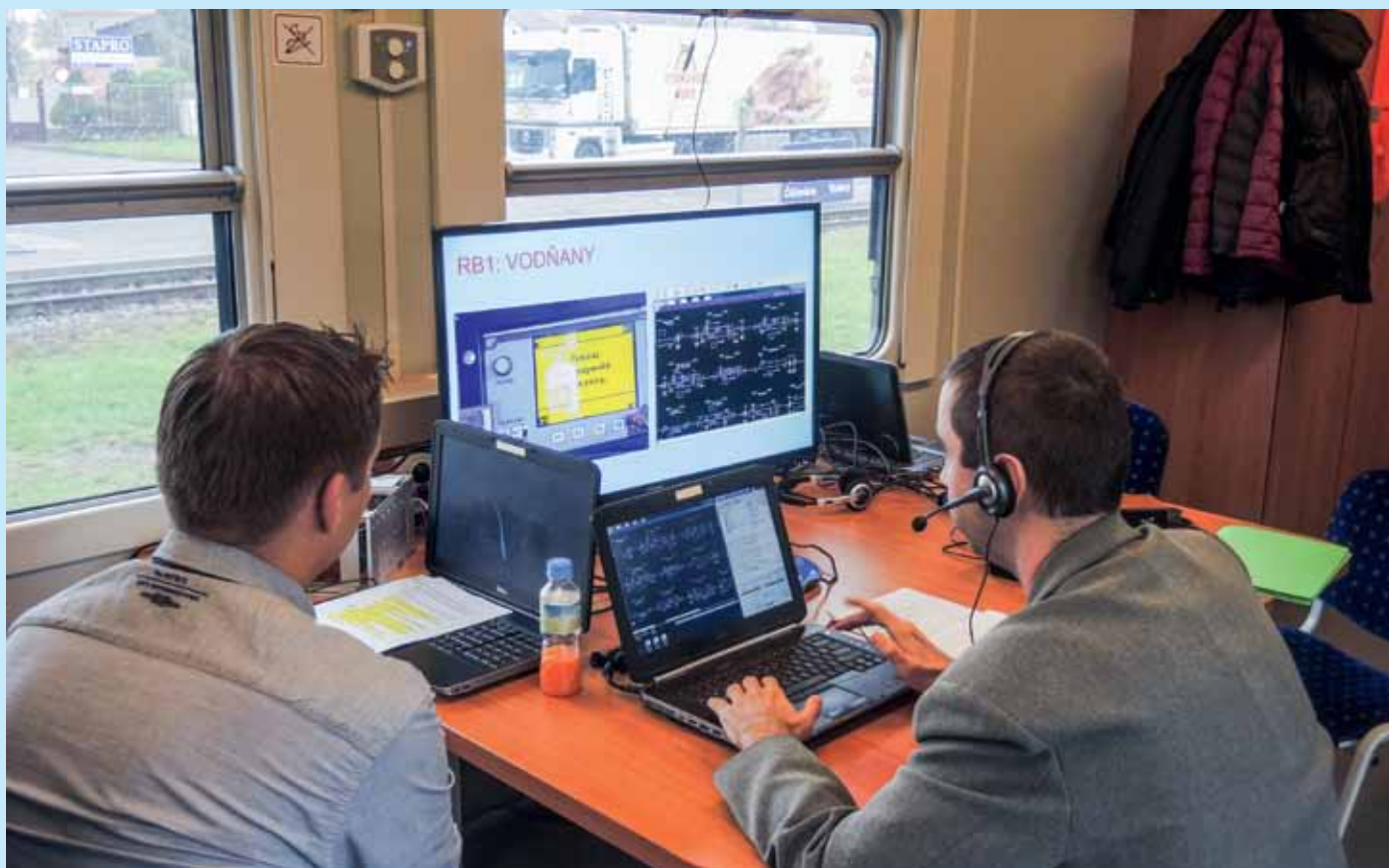
Obr. 10 Radiobloková centrála a zobrazovač jízdních stavů na palubě měřicího vozu
