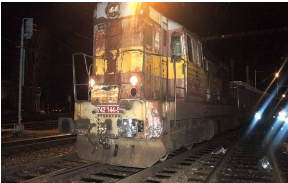
Obr. č. 4: Poškození čela HDV vlaku Mn 83044
