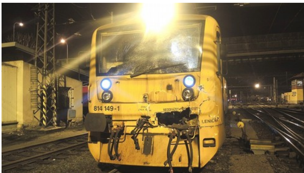
Obr. č. 3: Poškození čela posunového dílu dopravce ČD, a. s. Zdroj: Dražní inspekce
