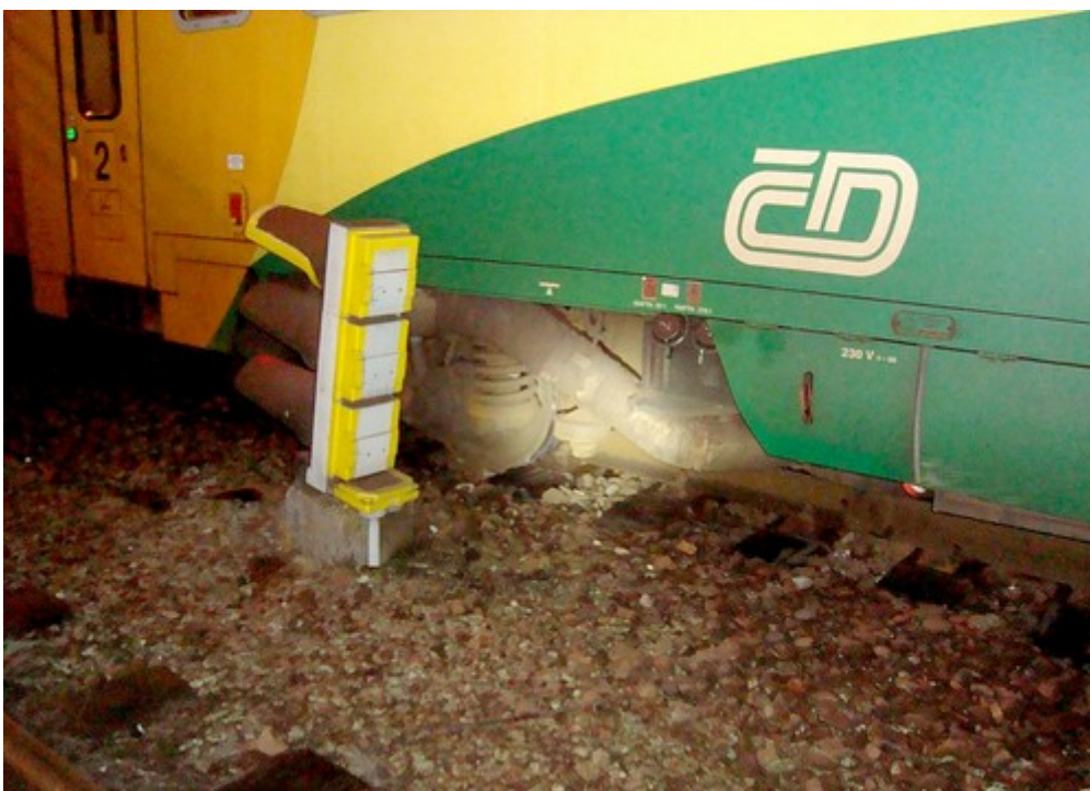
Obr. č. 5: Návěstidlo L6 a vykolejené dvojkolí HDV 814.149-1
