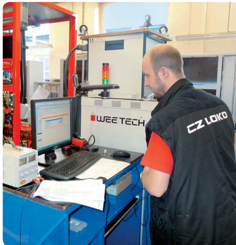
Další posilou Servisu Východ se stane Jakub Hradecký z provozovny Jihlava, který na snímku nastavuje tester W454. Ten je určen pro zkoušení funkčnosti elektronických zařízení lokomotiv vyráběných převážně na export.
