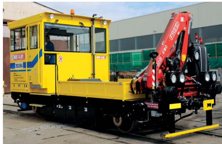
Speciální drážní vozidlo MUV 74.001 s hydrostatickým přenosem.
