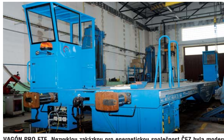
VAGÓN PRO ETE. Nezvyklou zakázkou pro energetickou společnost ČEZ byla modernizace železničního vozu, na němž se zavází jaderné palivo do Elektrárny Temelín. Nyní je vybaven moderní plynulou regulací, ovládacím, pulty i kabinou s 12 milimetrovým sklem kvůli bezpečnosti obsluhy.
