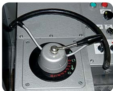
V CZ LOKO vyrobený kontrolér už osazený v lokomotivě.
